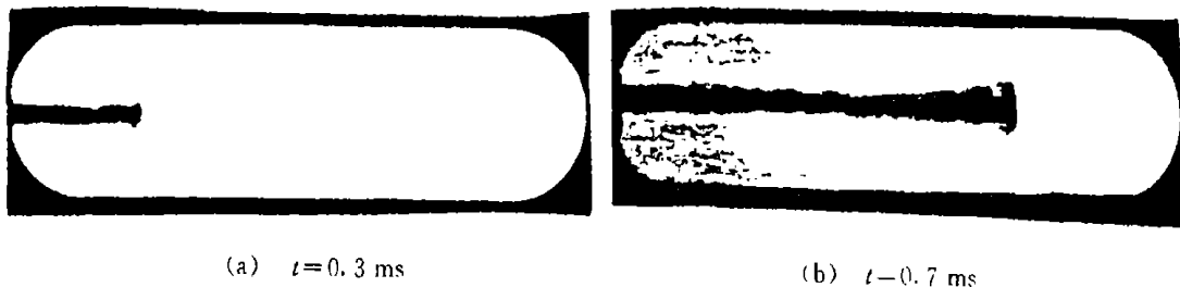
图 4 射流瞬态发展过程
